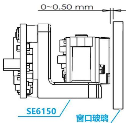
窗口的安装应尽可能贴近于SE6150引擎的前部，并平行于前端平面，其距离是通过测量引擎前端平面与窗口最远平面距离得到。为得到良好的识读性能表现，需避免引擎的照明光线通过窗口反射进入引擎，所以同时应尽可能减少窗口材料的厚度。如下图，窗口远端面与SE6150前端面垂直距离不超过0.5mm，同时窗口的近端面最好与引擎前端面接触。
